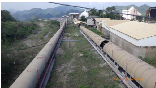
รูปที่ 2-11 ระบบ Bag Filter จุดถ่ายโอนต่างๆของสายพานลำเลียง
